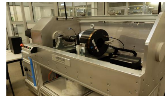
Ill. 7. Machine de type Kistler pour tester les connexions filetées.
